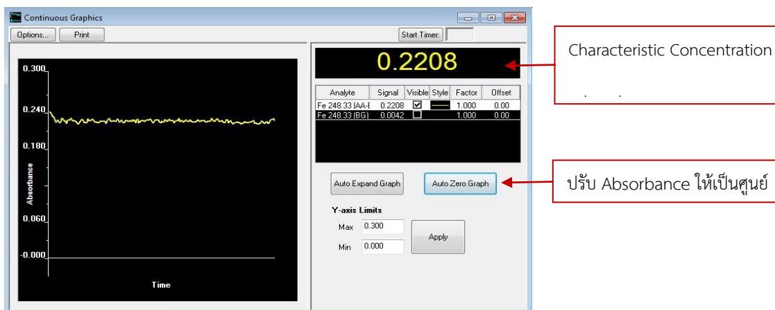
ภาพที่ 19 การ Check Sensitivity ของเครื่อง FAAS
