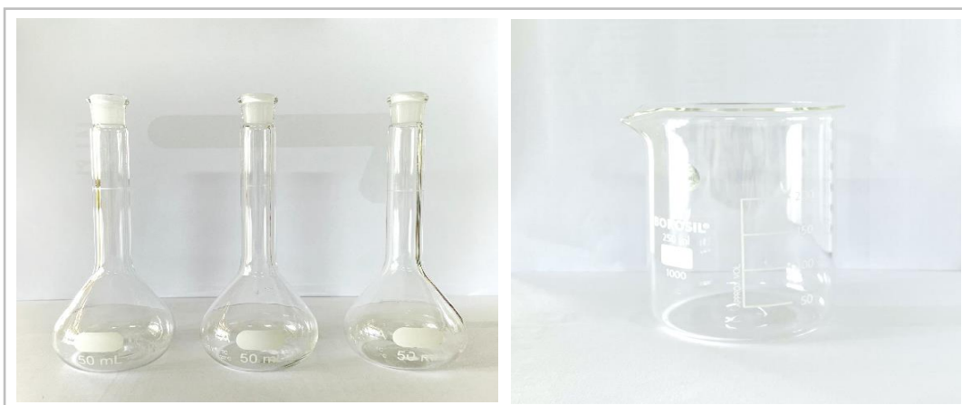
ภาพที่ 30 Volumetric Flask 50 มิลลิลิตร และ Beaker 250 มิลลิลิตร
