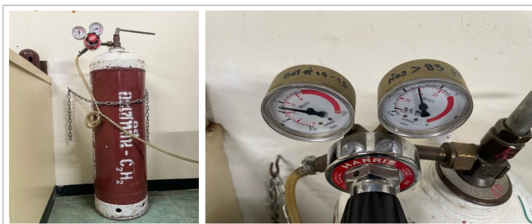
ภาพที่ 29 ถังแก๊ส Acetylene และเกรว็ดความดันภายในถังและความดันเข้าเครื่อง FAAS
